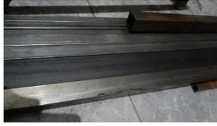
Gambar 27. Besi /logam bebentuk pipa kotak dan bulat
