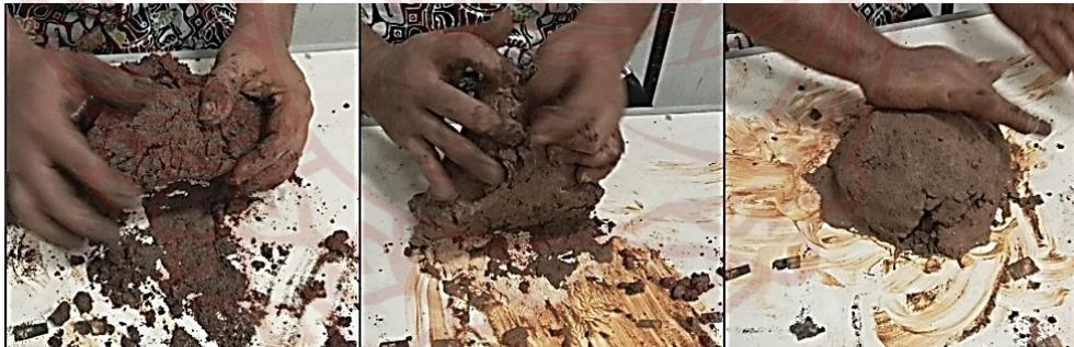
**Gambar 10.** Proses mencampurkan material komposit dengan teknik *kneading*
