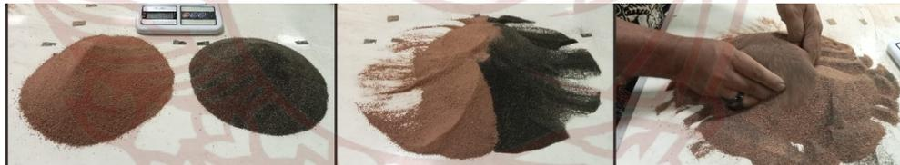
**Gambar 8.** Proses mencampurkan tanah dan pasir besi murni
