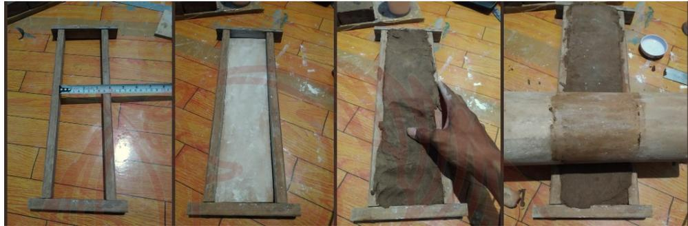
**Gambar 11.** Proses pemadatan material komposit untuk membuat lempeng bilah saron
