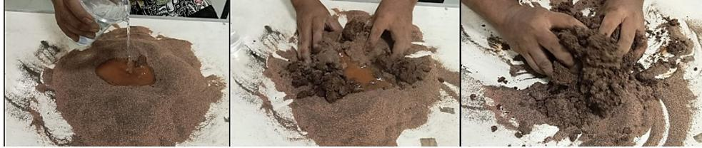
**Gambar 9.** Proses mencampurkan air untuk meliatkan komposit material
