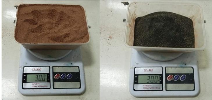
**Gambar 7.** Proses menimbang material tanah liat dan pasir besi murni
