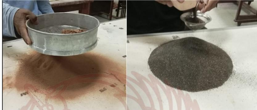
**Gambar 6.** Proses penyaringan material tanah liat dan pasir besi
