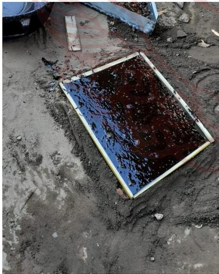
Foto 13. Proses jabung, persiapan pembuatan ukir logam.
