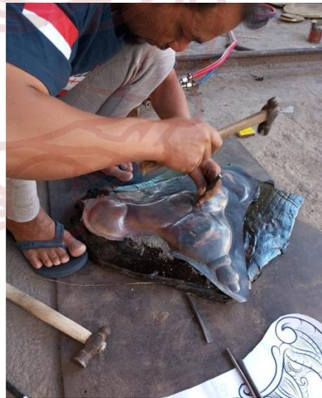
Foto 14. *Wudulan*, proses pemahatan tahap 1 pada tembaga. Pada bagian ini peneliti menggunakan jasa artisan pengrajin logam dengan desain dari peneliti.
