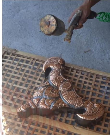
Foto 20. Proses pelapisan menggunakan clear glass.
