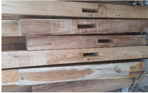
Gambar 36 Pembuatan konstruksi kerangka kursi
