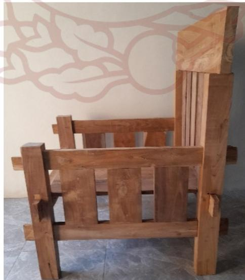
Gambar 38. Perakitan kerangka konstruksi kursi tampak samping.
