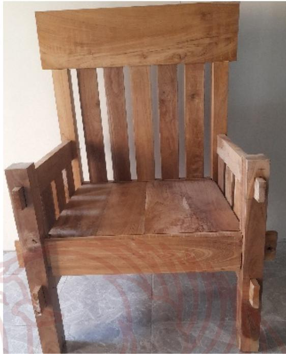
Gambar 39. Perakitan kerangka konstruksi kursi tampak depan
