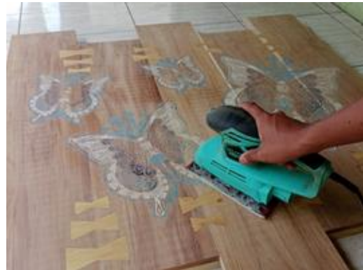
Gambar 23: Penghalusan permukaan kayu menggunakan amplas
