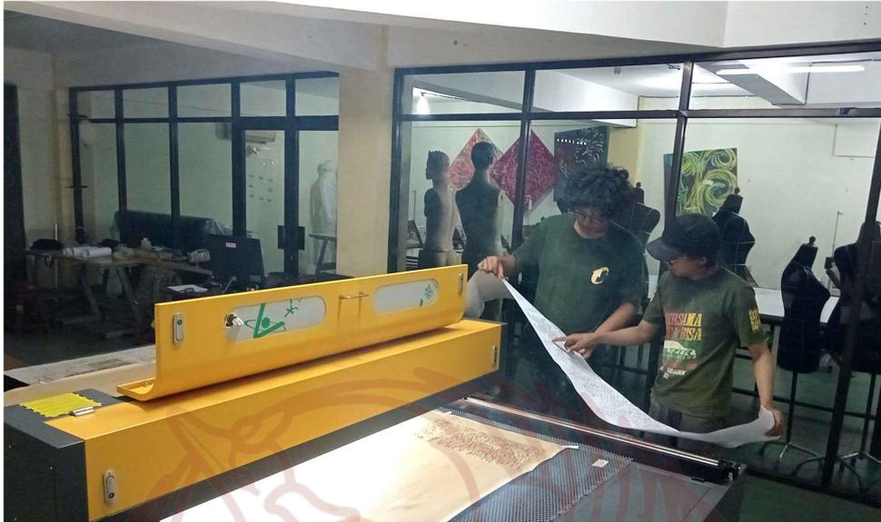
Gambar 10. Proses *cutting* wayang beber dengan peralatan CNC (laser)
