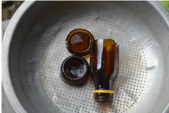
Gambar 7. Beling warna coklat yang telah dicuci Warna coklat pada kaca disebabkan adanya perpaduan besi (III) oksida, sulfur ataupun karbon. 18
