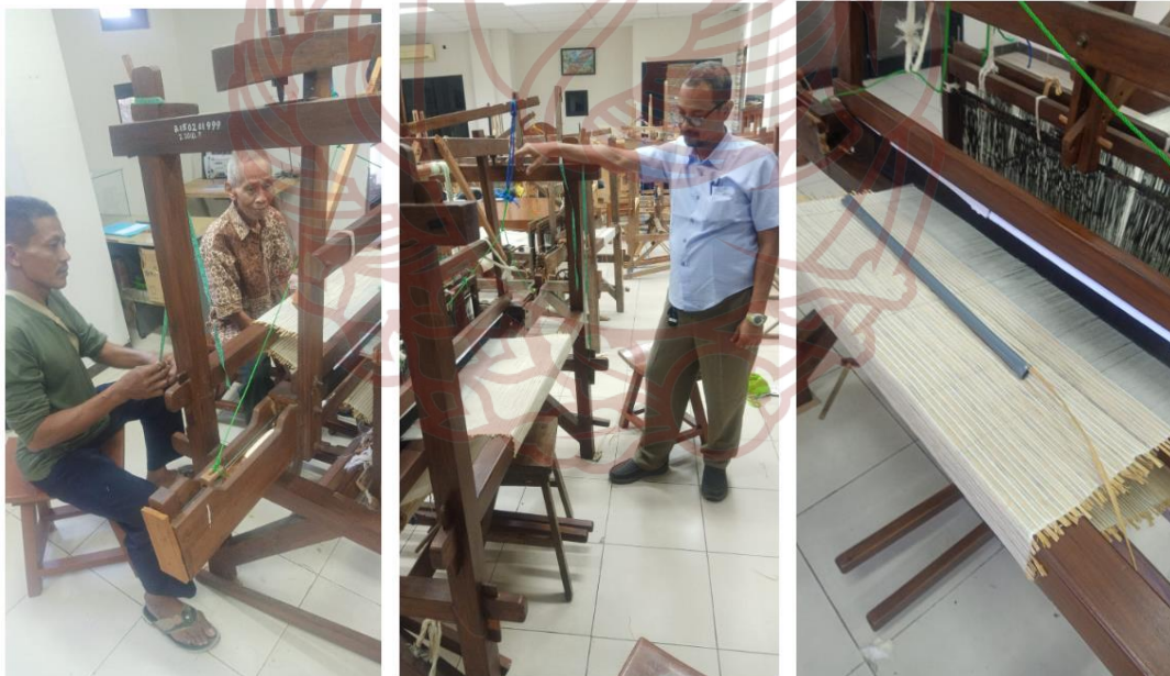
Gambar X: Proses penenunan bilah serat rotan di laboratorium tenun.
