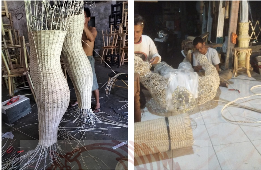
Gambar 16. Kombinasi anyaman rotan pada kerangka patung
