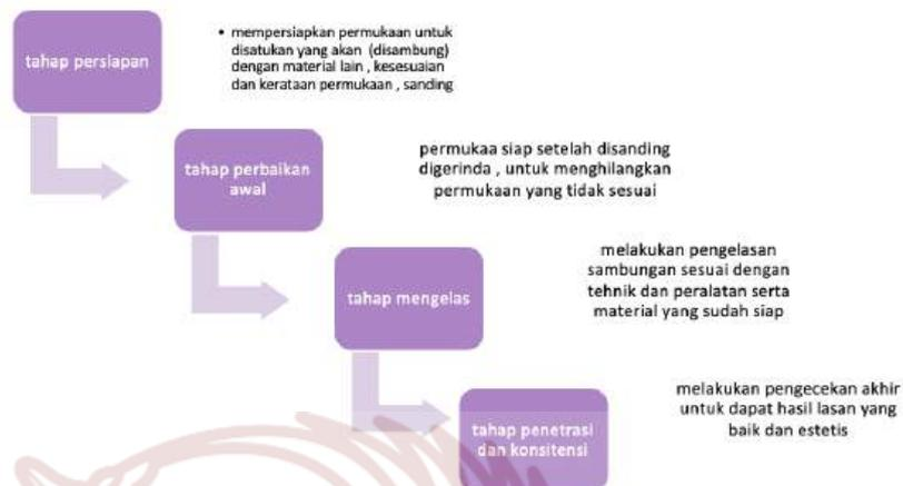
Gambar 10. Bagan tahapan perakitan produk reuse (bagan : Agung Purnomo, 2024)
