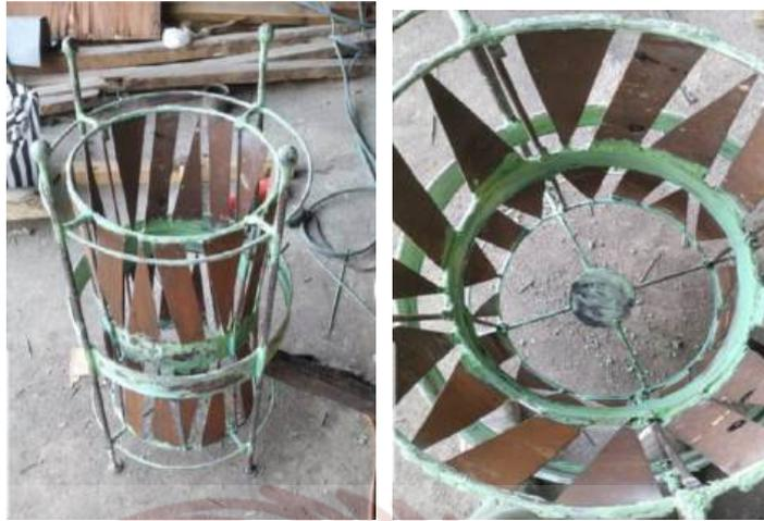
Gambar 12. Produk desain aksesoris yang telah diperbaiki permukaan dan siap difinishing akhir/top coating
