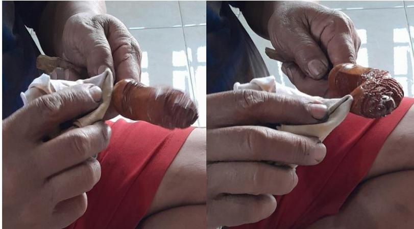
**Gambar 30.** Proses finishing dengan melapisi politer pada permukaan *deder/hulu* keris
