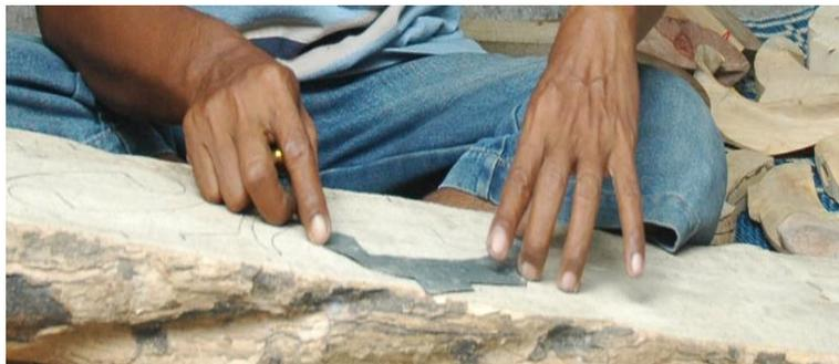
**Gambar 15.** Membuat gambar dengan pola/*mal*. (foto dan scan: Kuntadi WD 2024)
