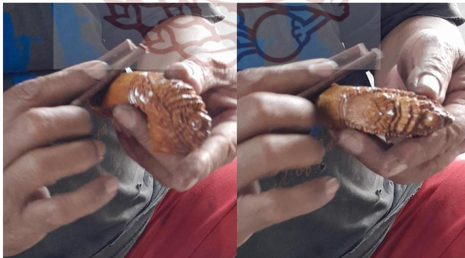
**Gambar 29.** Proses menghaluskan permukaan *deder/hulu* dengan amplas sebelum dilapisi politur (Foto dan scan. Kuntadi WD. 2024)
