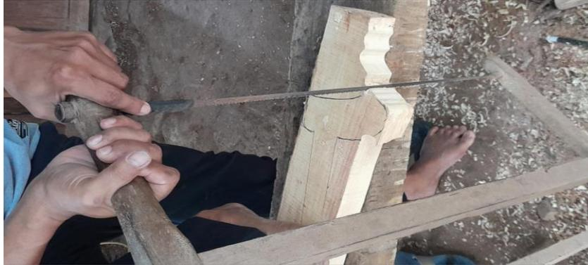
**Gambar 16.** Memotong dan membelah bahan warangka keris secara manual dengan gergaji (foto dan scan: Kuntadi WD 2024)
