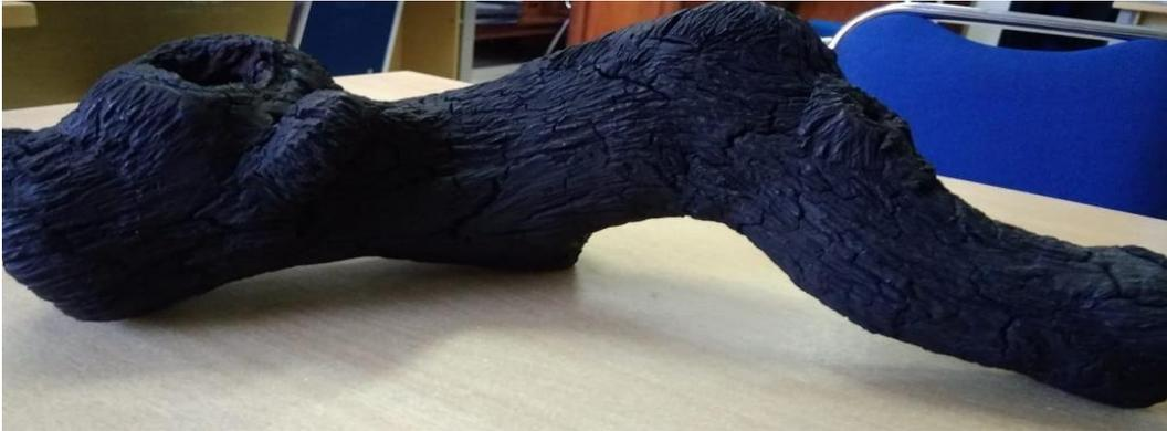
Gambar 3. Hasil eksperimen penerapan Alumina/aluminium Clay Sintetik pada potongan kayu sebagai finishing kayu, bentukan karakter arang kayu pada permukaan potongan kayu. (Foto . Afrizal,2023)
