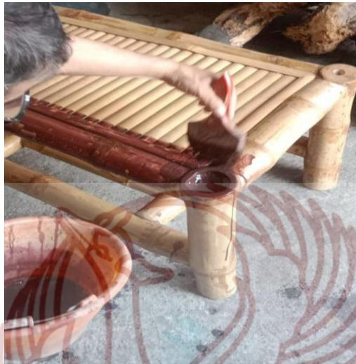
Gambar 25. Pemberian warna dasar pada permukaan produk bambu dengan larutan lem voc dan pigmen, teknik ini dilakukan untuk semua produk bambu yang akan diukir.
