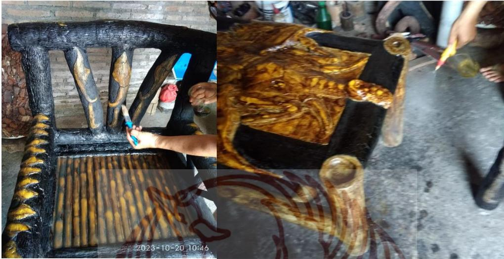
Gambar 32. Teknik finishing melamin clear pada ukiran aliminium clay sintetik. Teknik kuas dan teknik seprot.
