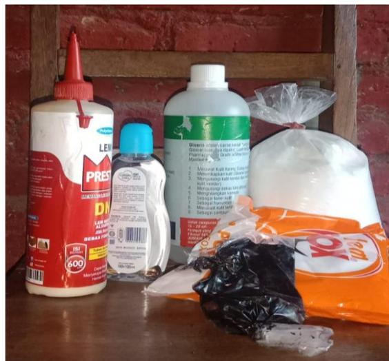
Gambar 6. Bahan dasar dalam komposisi pembuatan adonan pasta Aluminium clay sintetic.
