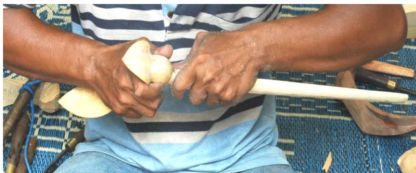
Gambar 21. Proses memasang gandar pada daun warangka. ( Foto dan scan. Kuntadi WD. 2023)
