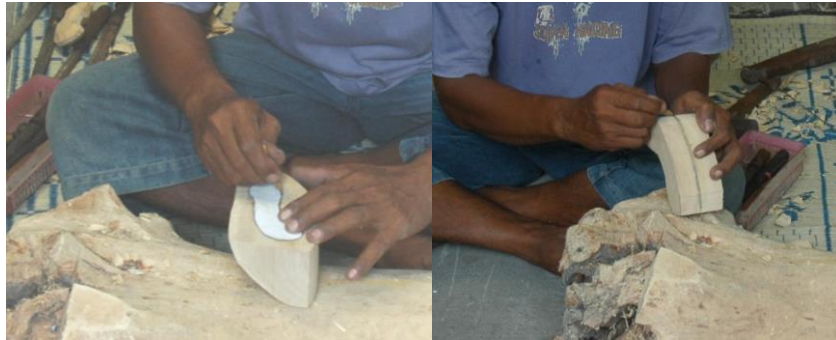
Gambar 10. Proses membuat pola dengan ngemal/ngeblak (foto Kuntadi 2023)
