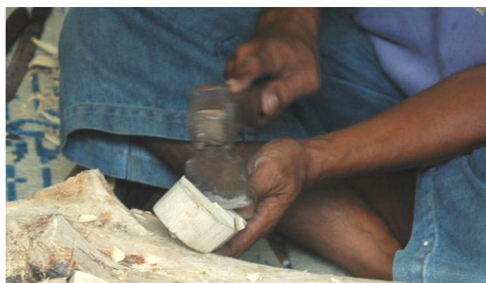
Gambar 12. Proses membuat bentuk awal dengan alat pethel (foto Kuntadi 2023)
