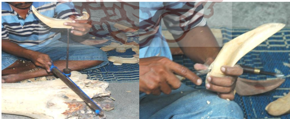
Gambar 19. Proses membuat lubang tempat gandar. ( Foto dan scan. Kuntadi 2023 )
