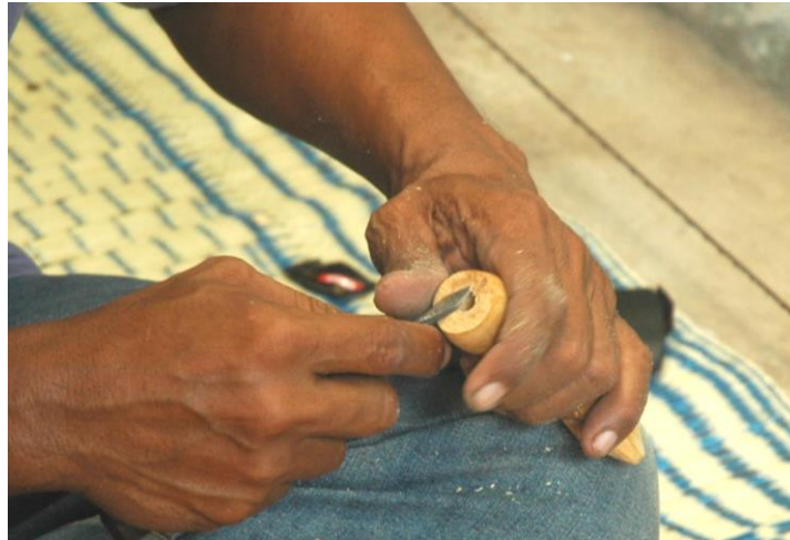
Gambar 15. Membuat lubang pesi dan tempat mendhak keris (foto Kuntadi 2023)
