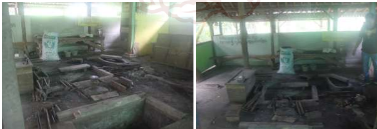
Penataan Area Penempaan di Besalen Empu Ngadeni terdapat dua cerukan tanah untuk empu pande dan panjak . Penempaan dilakukan dengan sistem berdiri.
