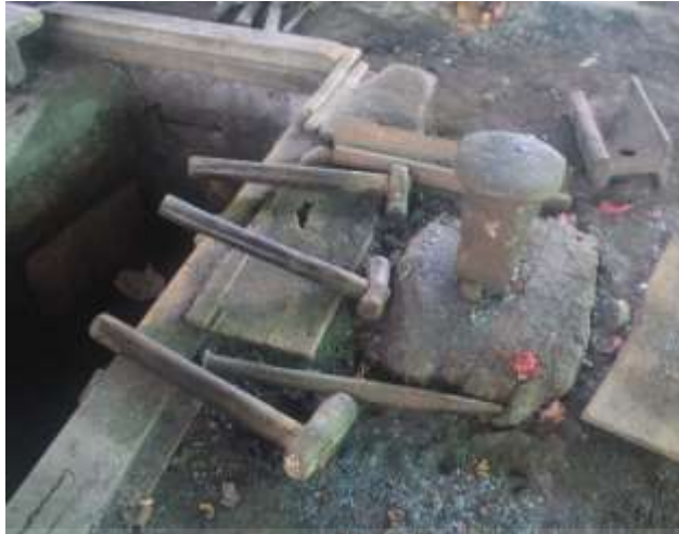
Model paron atau Landasan Tempa di Besalen Empu Ngadeni
