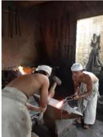
Gambar 9 Foto proses penempaan dengan posisi berdiri
