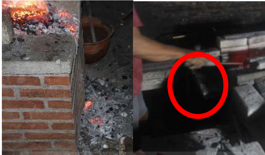
Penambahan komponen struktur perapen untuk membatasi bara arang agar tidak jatuh ke lantai. Foto disebelah kiri adalah perapen di besalen museum keris, sementara foto sebelah kanan adalah di besalen Empu subandi.
