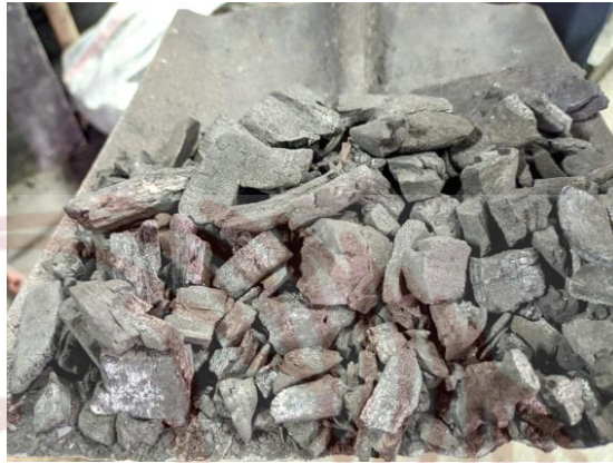
Gambar 5. Arang kayu jati sebagai bahan bakar (Foto : Muhammad Ra'uf Dwi Fajri 2022)
