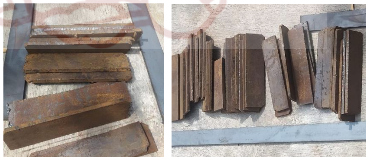
Gambar 2 : Besi plat sebagai Bahan bilah keris ukuran Panjang 20 cm, lebar 8 cm, dan tebal 1 cm. (Foto : Bening Tri Suwasono, 2022)
