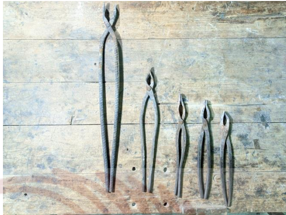
Gambar 9. Penjepit besi dalam berbagai ukuran (Foto : Priyo Widodo Setiadi 2022)
