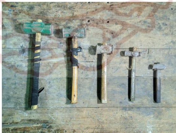
Gambar 10. Palu besi dalam berbagai ukuran (Foto : Priyo Widodo Setiadi 2022)
