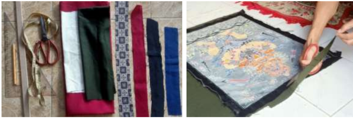
Gbr.45. Beberapa peralatan dan bahan untuk pembuatan plisir batik hias berupa: penggaris, kuter, gunting, meteran dan mesin jahit. Kanan: memotong kain untuk pelapis belakang.
