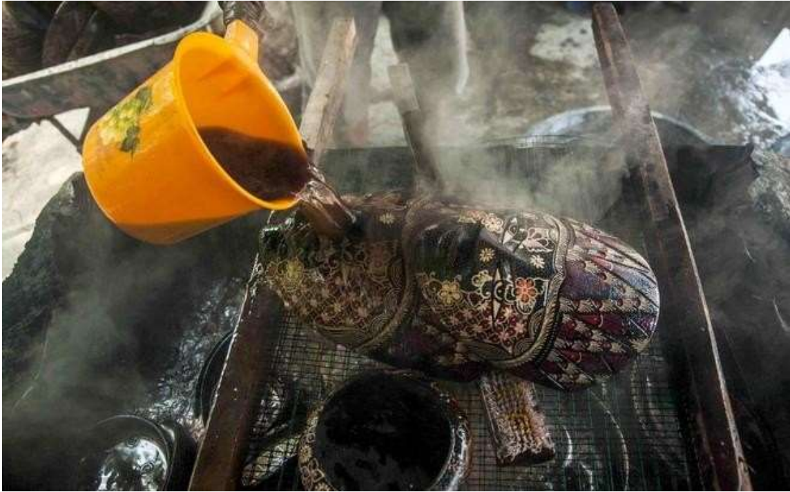
Gbr. 91. Tahap kelima: proses pelorodan (menghilangkan) malam batik menggunakan air panas. (Sumber : https://finance.detik.com/foto-bisnis/d-4163490/berkenalan-dengan-kerajinan-batik-kayu-krebet-khas-yogyakarta/6 )
