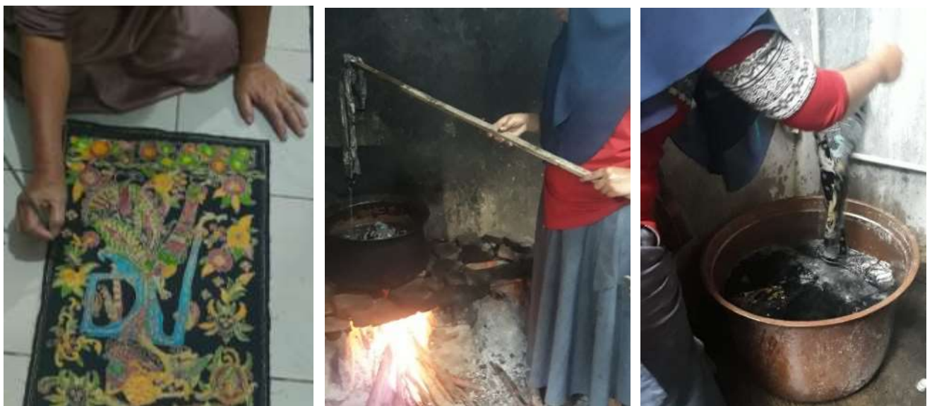
Gbr. 44. Dari kiri: proses mewarna remasol dengan teknik colet. Tengah, kanan: proses pembersihan malam dengan direbus pada air hingga mendidih, diangkat dengan tongkat, dicuci hingga bersih dan dikeringkan.
