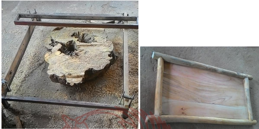
Gambar 8. Alat untuk pembuatan groove papan panel kayu dan pemasangan panel sisi samping dan sisi atas.
