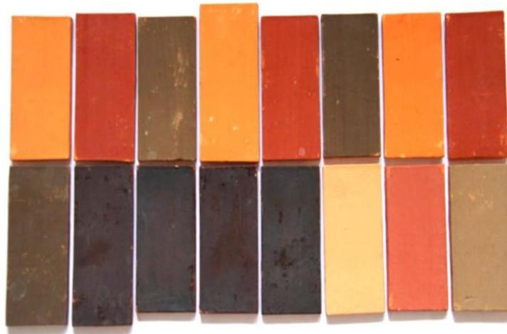
**Gambar 152.** Testpiece engobe dengan komposisi berbasis bahan lokal Plered
