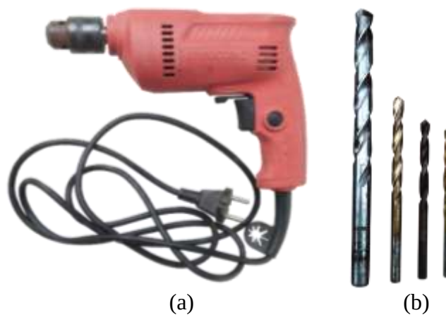
Gambar 85. (a) Bor genggam, (b) Ragam mata atau pisau bor genggam, (dari kiri) ukuran \varnothing 8 mm, \varnothing 4 mm, \varnothing 3 mm, \varnothing 2,5 mm (Dokumentasi: Achmad Fathony, 2019)
