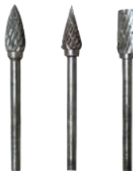
Gambar 83. Mata atau pisau hanging grinder dari bahan tungsten steel (Dokumentasi: Achmad Fathony, 2019)
