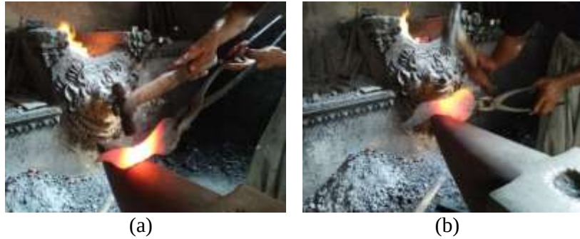
Gambar 106. (a) Penempaan bagian beuteung , (b) Penempaan bagian tonggong (Dokumentasi: Achmad Fathony, 2019)
