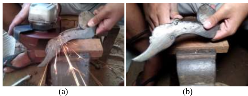
Gambar 123. (a) Penggerindaan bagian tepi bakalan waruga , (b) Pembentukan gigi/rigi (Dokumentasi: Achmad Fathony, 2019)
