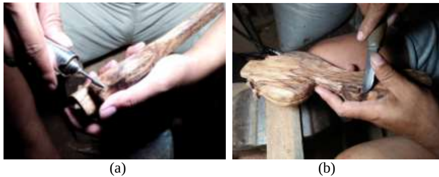
Gambar 166. (a) Pembentukan detail kowak menggunakan mini grinder , (b) Pembentukan ukel/ulir (Dokumentasi: Achmad Fathony, 2019)
