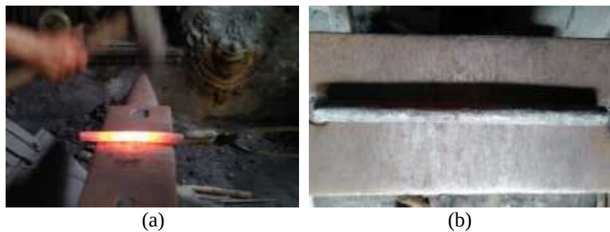
Gambar 121. (a) Saton ditempa berbentuk silinder , (b) Hasil penempaan bakalan methuk (Dokumentasi: Achmad Fathony, 2019)
