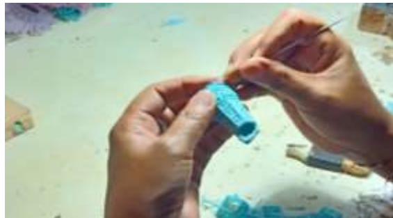
Gambar 205. (a) Membersihkan master lilin, (b) Menyusun master lilin (Dokumentasi: I Wayan Suarna, 2020)
