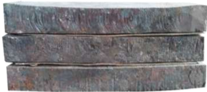
Gambar 101. Susunan besi dan nikel untuk membuat saton (Dokumentasi: Achmad Fathony, 2019)
