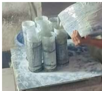
Gambar 206. (a) Menuang adonan gypsum ke dalam perforated flask , (b) Menghaluskan bentuk ali (Dokumentasi: I Wayan Suarna, 2020)
