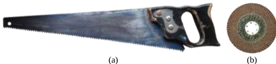
Gambar 95. (a) Gergaji, (b) Mata atau pisau angle grinder amplas (Dokumentasi: Achmad Fathony, 2019)
