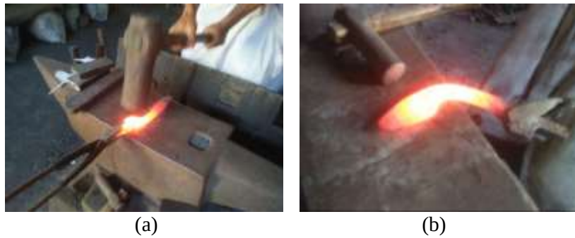
Gambar 108. (a) Penempaan bagian tadah , (b) Papatuk/congo ditekuk menghadap ke depan (Dokumentasi: Achmad Fathony, 2019)
