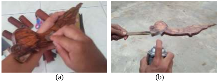
Gambar 188. (a) Pengamplasan kowak , (b) Penyemprotan clear (Dokumentasi: Achmad Fathony, 2019)
