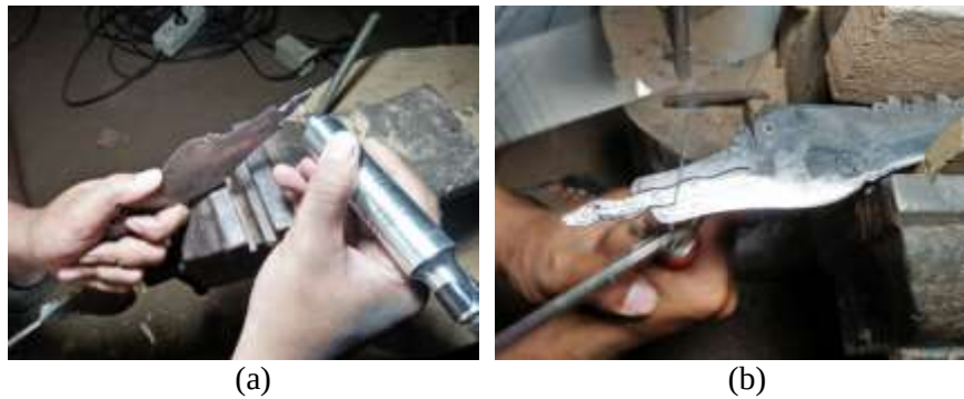
Gambar 144. (a) Pembentukan luk (luar) pada bagian papatuk menggunakan mini grinder , (b) Pembentukan luk (dalam) pada bagian papatuk menggunakan gergaji (Dokumentasi: Achmad Fathony, 2019)
