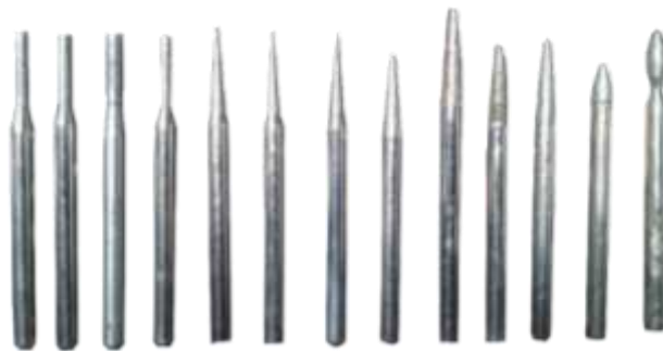
Gambar 82. Mata atau pisau hanging grinder dari bahan serbuk diamond (Dokumentasi: Achmad Fathony, 2019)
