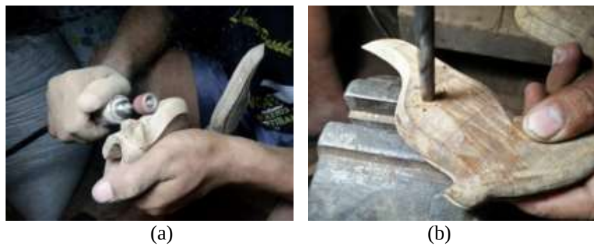
Gambar 174. (a) Pembentukan detail kowak menggunakan mini grinder , (b) Pengeboran lubang mata (Dokumentasi: Achmad Fathony, 2019)
