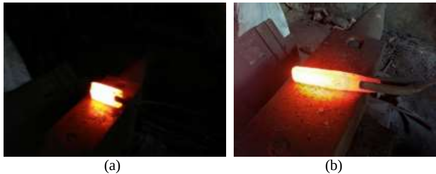
Gambar 120. (a) Hasil pelipatan saton , (b) Saton ditempa memanjang (Dokumentasi: Achmad Fathony, 2019)
