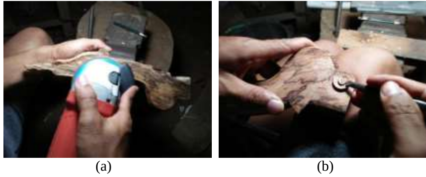
Gambar 187. (a) Pembentukan detail kowak , (b) Pembuatan ukel/ulir (Dokumentasi: Achmad Fathony, 2019)
