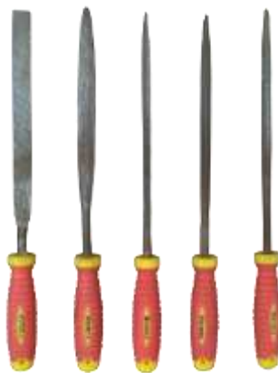
Gambar 90. Ragam bentuk dan ukuran kikir needles files (Dokumentasi: Achmad Fathony, 2019)
