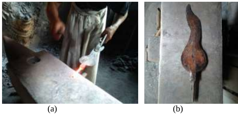
Gambar 107. (a) Penataan bentuk paksi/pasi , (b) Hasil penempaan bakalan waruga pertama (Dokumentasi: Achmad Fathony, 2019)
