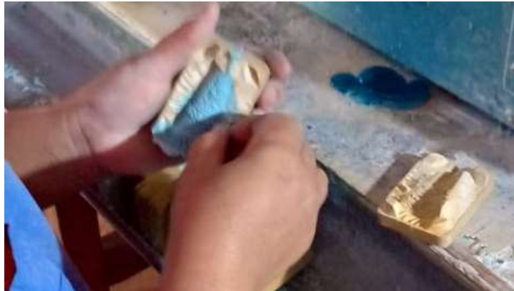
Gambar 204. Pembuatan master ali dari lilin (Dokumentasi: I Wayan Suarna, 2020)
