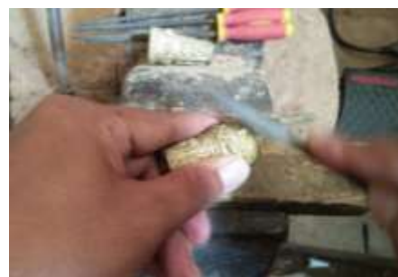
Gambar 206. (a) Menuang adonan gypsum ke dalam perforated flask , (b) Menghaluskan bentuk ali (Dokumentasi: I Wayan Suarna, 2020)
