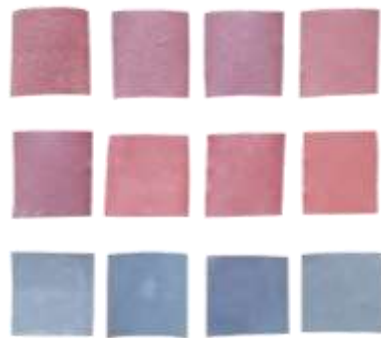
Gambar 97. Amplas (barisan atas dari kiri) nomor 80, 100, 120,150, (barisan tengah dari kiri) nomor 180, 240, 320, 400, (barisan bawah dari kiri) nomor 500, 600, 800, 1000 (Dokumentasi: Achmad Fathony, 2019)
