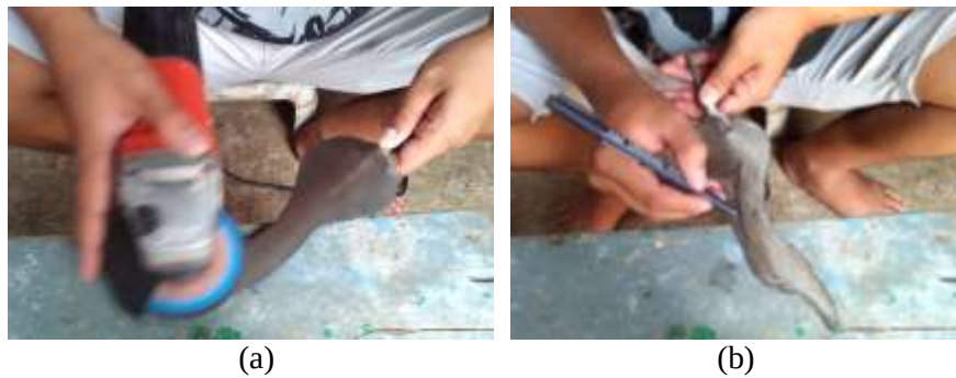
Gambar 122. (a) Menggerinda permukaan bakalan waruga , (b) Menyalin desain kumpang pada bakalan (Dokumentasi: Achmad Fathony, 2019)
