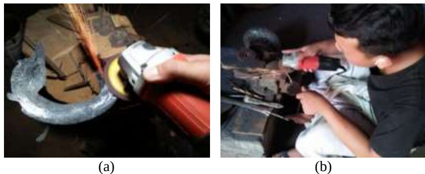
Gambar 131. (a) Mengikis ketebalan bilah, (b) Pembentukan paksi/pesi (Dokumentasi: Achmad Fathony, 2019)
