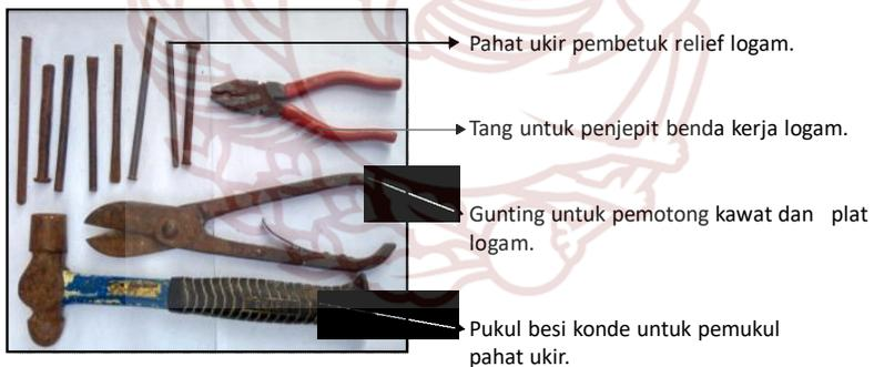
Gambar 85. Pahat ukir *endak-endakan dan wudulan*, tang alat penjepit, gunting plat logam dan palu konde untuk alat pengukiran relief dari logam, disesuaikan dengan besar kecil cekungan reliefnya.
