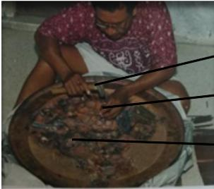
Cara mengukir negatif (cekungan) plat logam di atas kotak jабung.
