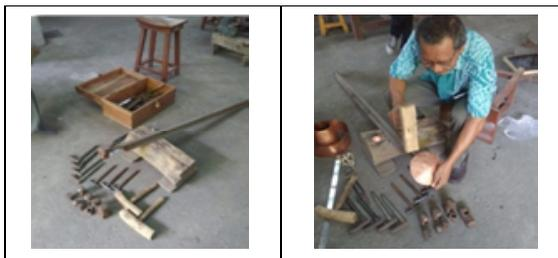
Gambar 56. Alat tempa dingin, dan praktek 'ondel' plat logam.
