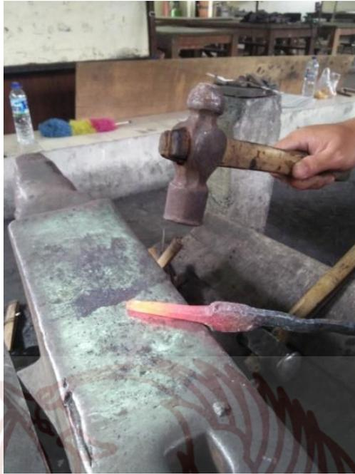
Gambar 133 : Proses membuat dan mengulur *pesi*.
