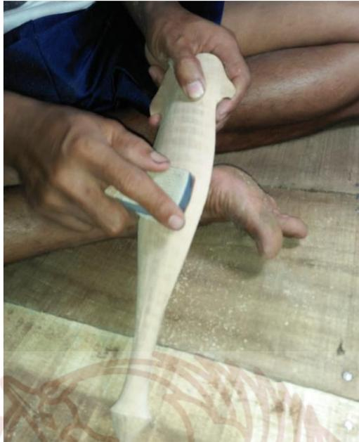
Gambar 162 : Proses menghaluskan permukaan warangka dengan amplas.
