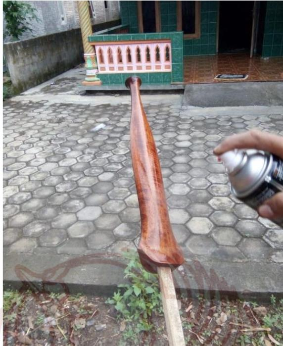
Gambar 164 : Proses finishing warangka dengan clear gloss
