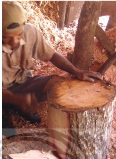
Gambar 77. Proses Menguliti atau Menghilangkan Kulit Pada Kayu (Untuk Mempermudah Proses Pembubutan) (Foto: Kurniawan Yuniarto, 2017)
