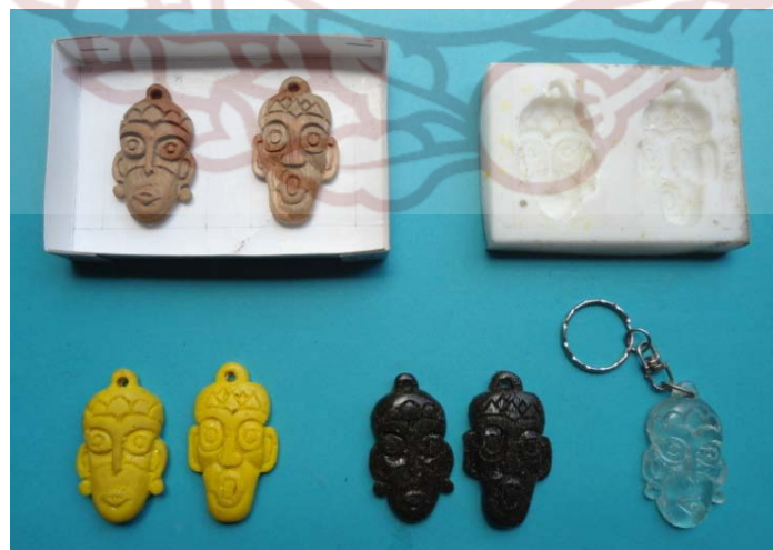
Gambar 23. Model Topeng Gantungan Kunci ditempel pada kotak kertas; Hasil cetakan dari Silicon; dan Hasil cetak Resin dicampur talk + sandy kuning, dicampur pasir (jadi hitam), dan resin bening.
