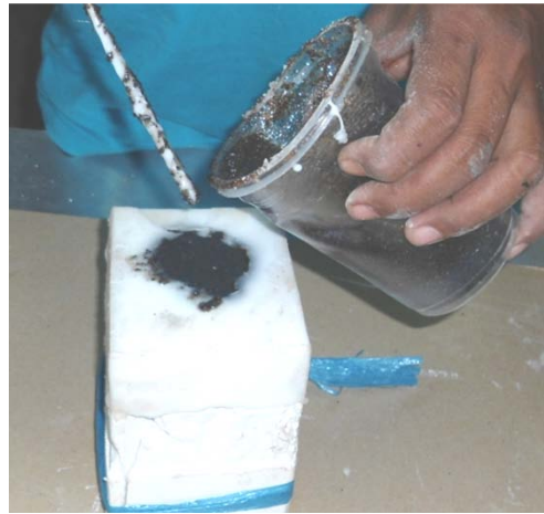
Penuangan Resin+Pasir ke Cetakan
