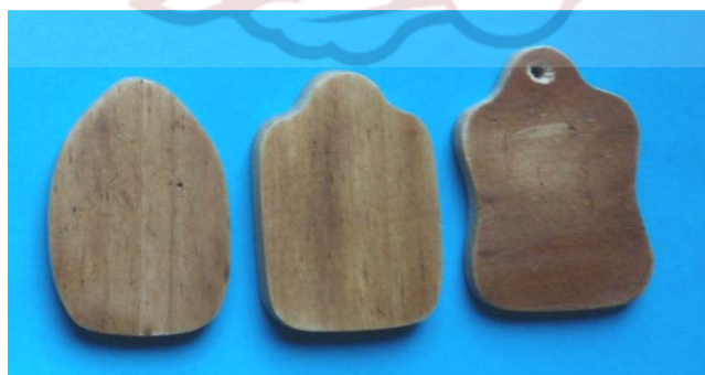
Gambar 12. Model dari kayu untuk pembuatan cetakan gantungan kunci yang bening dan diisi dengan foto wayang.
