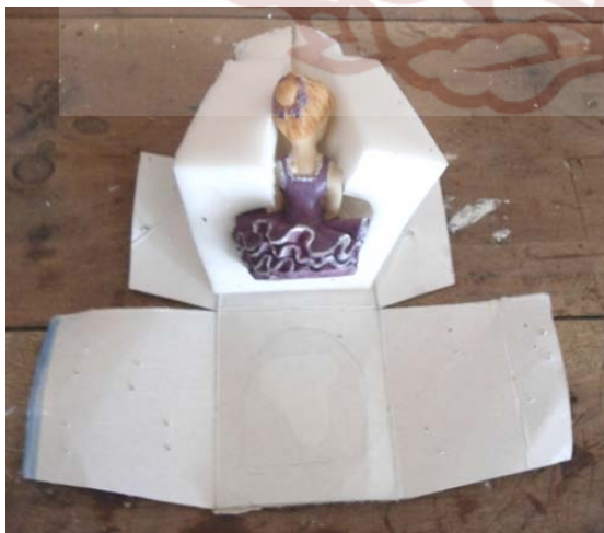
Gambar 46. Hasil cetakan dari Silikon, kemudian dirobek kertas pembungkusnya. Selanjutnya silicon dibelah separo dari bagian atas ke belakang dengan kater/ pisau, dan model/master patung diambil.
