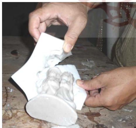
Gbr. 50. Kiri: Patung cetakan resin diambil dari cetakan silicon yang telah dibelah belakangnya. Kanan: Cetakan silicon tampak bawah, dan hasil cetakan patung ‘Temanten’ dari resin+ talk.
