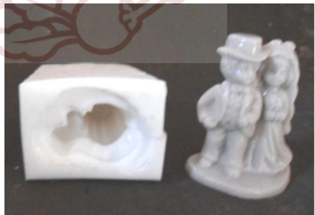
Gbr. 50. Kiri: Patung cetakan resin diambil dari cetakan silicon yang telah dibelah belakangnya. Kanan: Cetakan silicon tampak bawah, dan hasil cetakan patung ‘Temanten’ dari resin+ talk.
