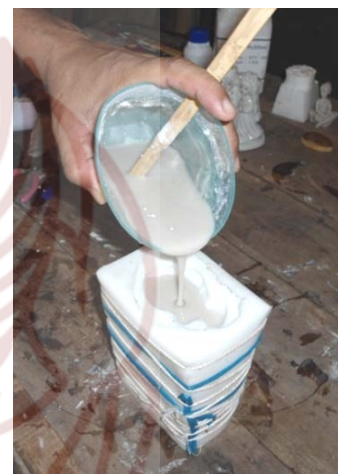
Gbr. 49. Kiri: Penuangan Silicon untuk cetakan. Kanan: Penuangan resin + talk pada cetakan Silicon
