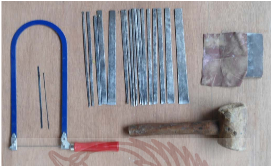
Gbr. 15. Beberapa peralatan untuk membentuk model dengan teknik ukir kayu, alatnya: gergaji kecil/triplek, pahat ukir, amlas dan palu dari kayu.
