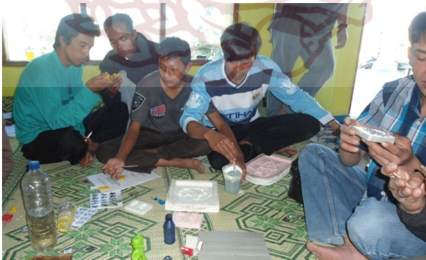
Gbr. 53. Peserta pelatihan sedang mencampur resin + talk + pewarna untuk dituangkan ke dalam cetakan.
