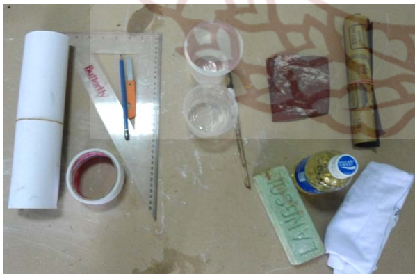
Gambar 20. Peralatan untuk cetak resin: Kertas, potlot, penggaris, kater, Solatif bolak-balik, wadah untuk mencampur silikon/resin, amlas dan alat pengkilap (batu Langsol, bensin & gombal)
