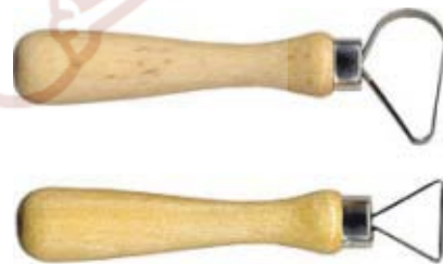
Gambar 18. Ribbon tools: Untuk mengerok, menghaluskan, dan merapikan benda kerja.
