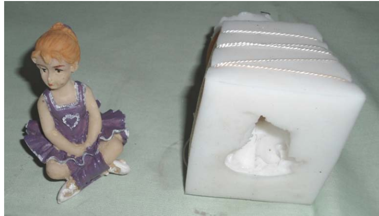
Gambar 47. Model patung “Gadis” dan hasil cetakan silicon yang diikat dengan tali mengelilingi cetakan, siap untuk dituang dengan resin + Katalis + talk.
