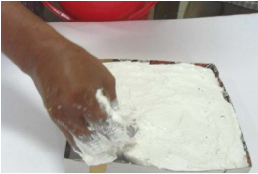
Gbr.33. Penuangan gips di atas Silicon, setelah gips mengering, diambil modelnya.
