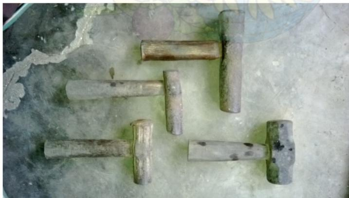
**Gambar 38.** Perlengkapan dan peralatan proses pembuatan gender barung : *Palu Geblok* dan *Palu Tempel*.
