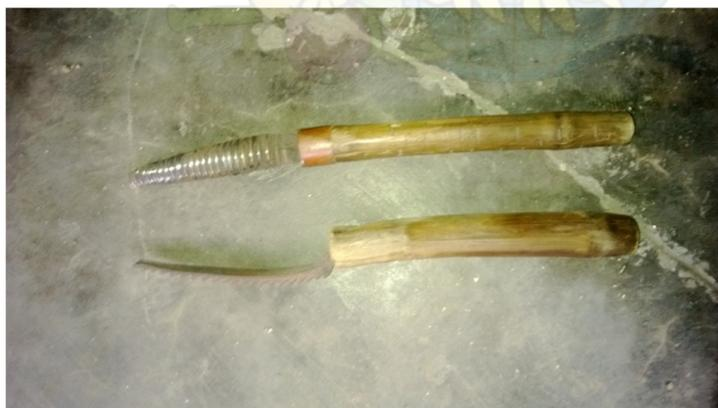
**Gambar 41.** Perlengkapan dan peralatan proses pembuatan gender barung : *Kikir Patar*.
