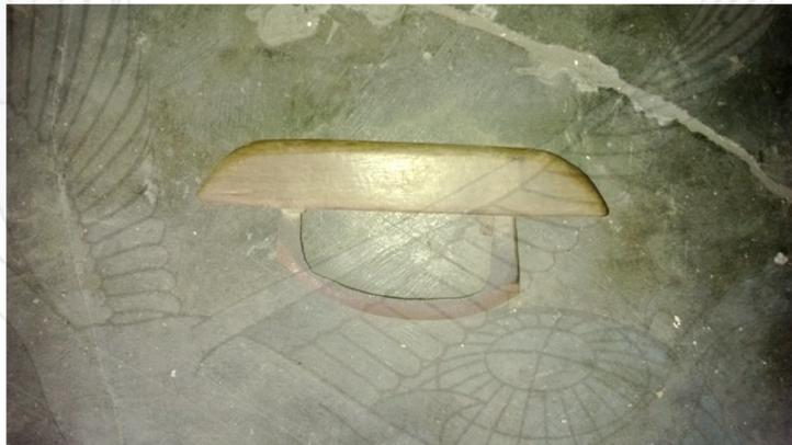
**Gambar 43.** Perlengkapan dan peralatan proses pembuatan gender barung : *Kesik*.
