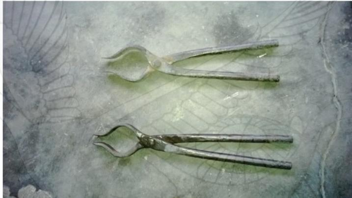
**Gambar 37.** Perlengkapan dan peralatan proses pembuatan gender barung : *Supit/Catut*.
