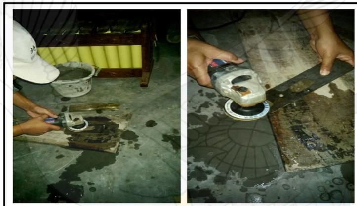
**Gambar 27.** Proses pengikiran dengan mesin gerenda.
