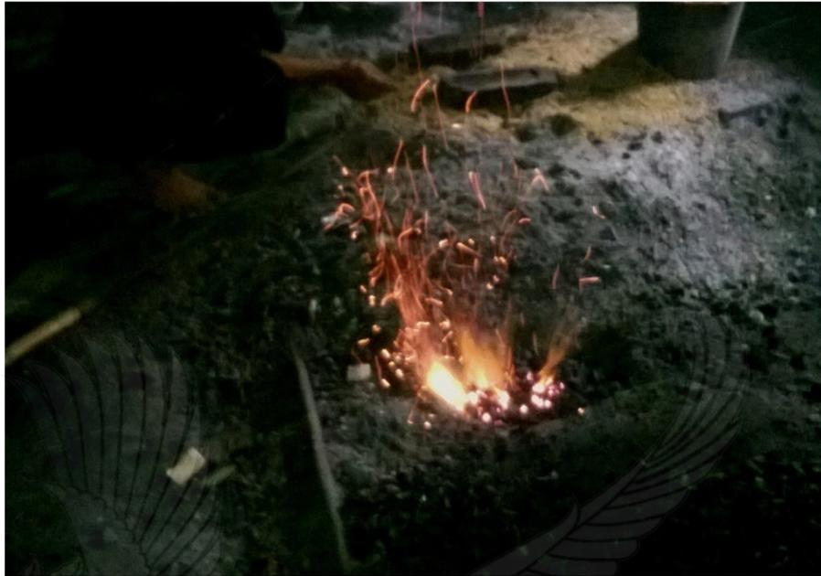
**Gambar 31.** Perlengkapan dan peralatan proses pembuatan gender barung : *Prapèn*.
