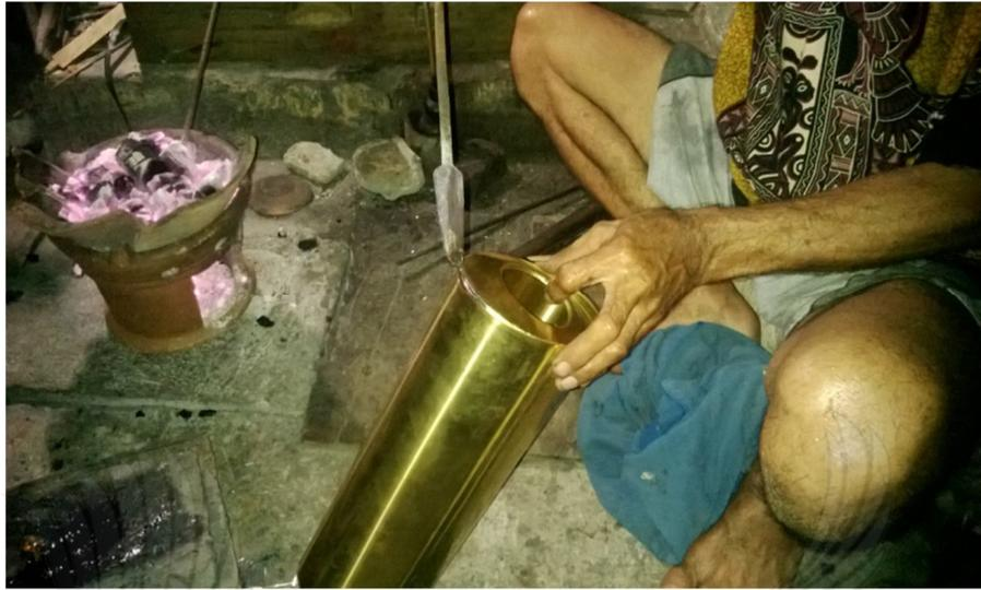
**Gambar 24.** Proses mematri *bubungan*.
